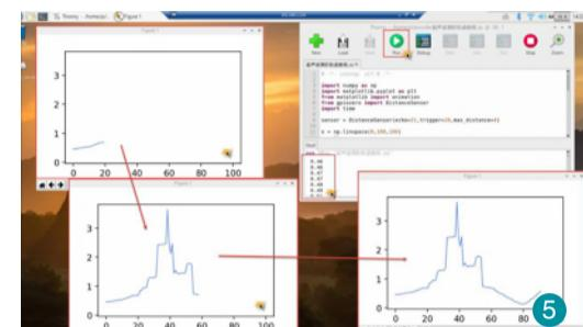
程序可以重复运行,获取到不同的超声波测距值,对应不同的动态轨迹曲线。而且,我们还可以修改程序中的循环次数(比如300),或是修改曲线绘制的速度(在变量ani调用animation.FuncAnimation()中“interval=50”处设置),当然也包括曲线的颜色、宽度等,都可以尝试。
